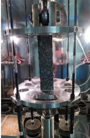
Abbildung 20: Eingespannter Prüfkörper während des Abkühlversuches (Bildquelle: Institut für Straßenwesen, TU Braunschweig).
