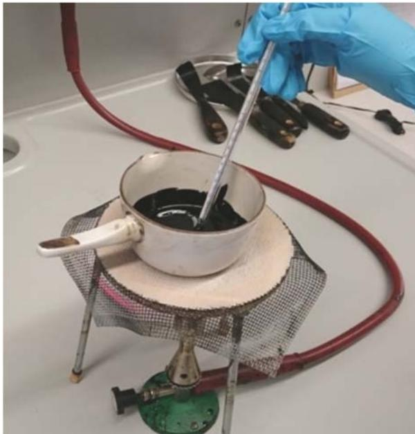
Abbildung 7: Homogenisieren und Temperaturkontrolle an der erwärmten und homogenisierten Bitumenmischung.
