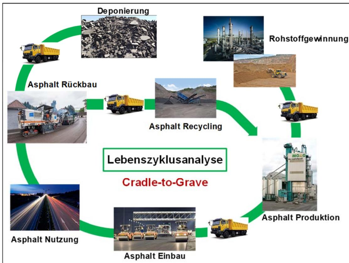
Abbildung 26: Lebenszyklus der betrachteten Asphalte: Von der Rohstoffgewinnung, zur Asphaltproduktion, zu Einbau & Nutzung bis zum Rückbau und zur Deponierung. Auch alle Transporte zwischen den einzelnen Lebenszyklusphasen sind in der Ökobilanz berücksichtigt. Diese Wahl der Systemgrenze wird als "Cradle-to-Grave = von der Wiege bis zur Bahre" bezeichnet (Bildquelle: Pohl, 2020).
