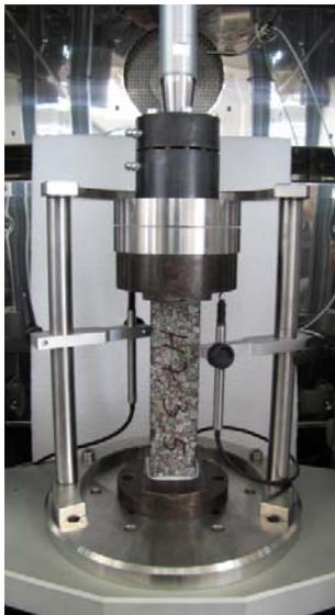
Abbildung 21: Eingespannter Prüfkörper während des Zug-Schwellversuches (Bildquelle: Institut für Straßenwesen, TU Braunschweig).
